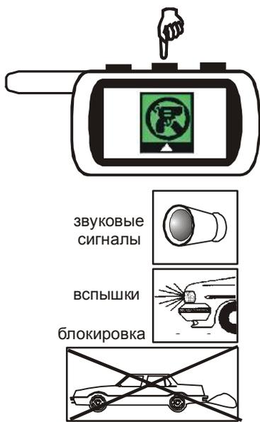
Для включения режима антиграбления переместите курсор на иконку
