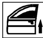
**Вариант 2** - канал автоматически активизируется только при включении режима охраны. Продолжительность работы канала 20 или 30 секунд программируется при установке системы. На время активизации канала система не реагирует на датчик удара для избежания ложных срабатываний. Этот алгоритм может быть использован для автоматического поднятия стекол при включении режима охраны.
