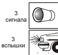
Для включения режима “паники” при выключенном зажигании одновременно нажмите и удерживайте кнопки 1 и 2 брелка в течение 3 секунд.
