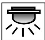
**Вариант 1** - канал автоматически активизируется при выключении режима охраны и одновременно с появлением сигналов тревоги при включенном режиме охраны. Продолжительность работы канала 20 или 30 секунд программируется при установке системы. Этот алгоритм может быть использован, например, для включения «вежливой» подсветки салона.
