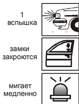
Перед включением режима охраны убедитесь, что зажигание выключено, двери, капот, багажник надежно закрыты, стояночный тормоз включен. Для включения режима бесшумной охраны установите курсор на иконку
